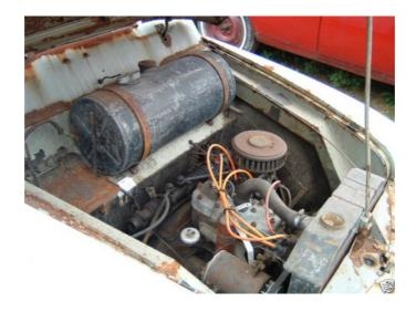
Deutlich erkennbar der mittig geänderte Anschluss des Wasserstutzens und die seitliche Anordnung der Zündkerzen.
